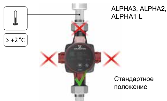
Рис. 17 Возможное положение блока управления для системы отопления
